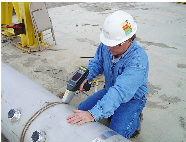
Figura 48 - Verificação por PMI
