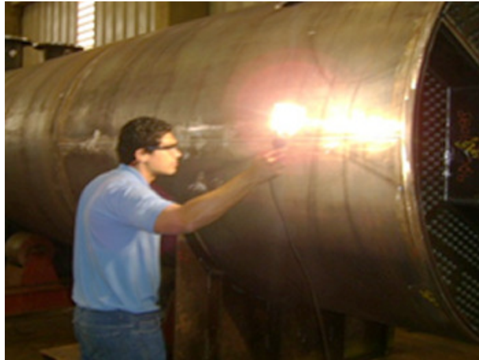
Figura 7 - Ensaio visual de solda com iluminação auxiliar
